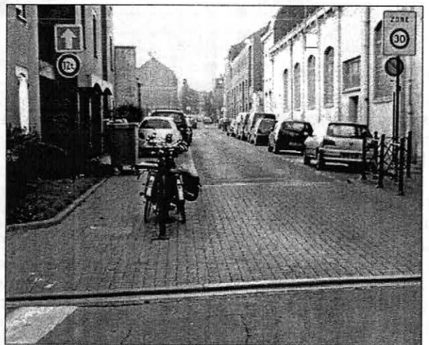
plateau borduré traversant en entrée de zone 30 rue Lamartine à Lille (signalée par fiche de proposition n°15)
